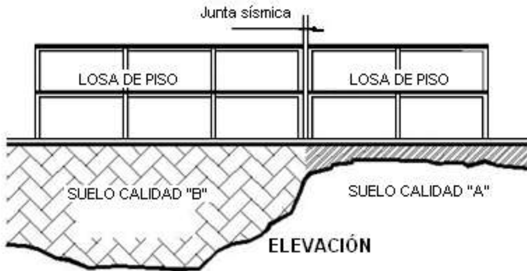
Figura 4. Requerimiento de junta sísmica por cambio en la calidad del suelo
