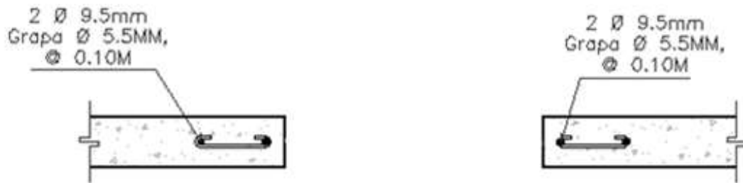
Fig. 18-i Detalle típico de refuerzo en hueco de puerta y ventana
